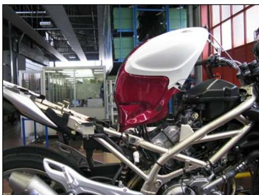
**I)** Con l'installazione dei collettori "Leovince SBK" il punto di fissaggio della sonda Lambda si viene a trovare sul lato destro della moto, contrariamente alla posizione originale.
