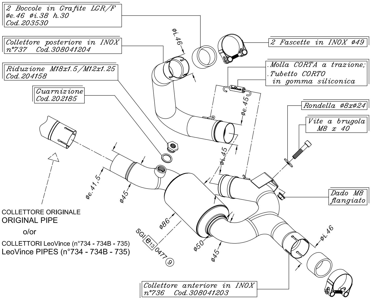
I - Componente fornito in confezione e da utilizzare sulle motociclette non dotate di sonda Lambda:
